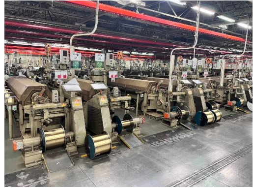
รูปที่ 2 การปิดครอบอุปกรณ์เครื่องจักรที่มีเสียงดัง
